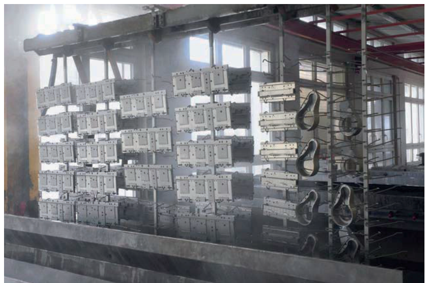
Bild 1: Warenträger aus der Eloxalanlage beim Einfahren in den Gestelltrockner. Bei einer Temperatur von 65 °C werden die Bauteile in 15 min vollständig und fleckenfrei getrocknet.
