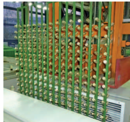
Die Airgenex-Module – hier im Bild: Gestell-trocknung von Kleinteilen – können auch in bestehende Trockenzonen integriert werden.
