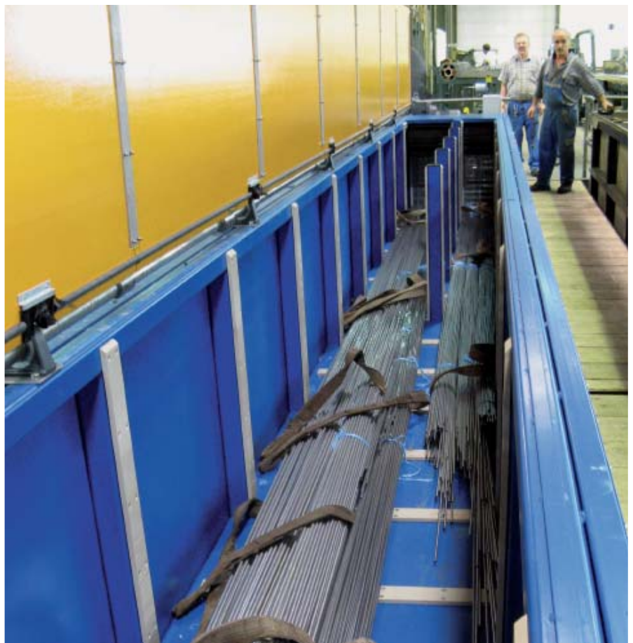
Rohrbunde unterschiedlichster Dimensionen im Trockentrog
