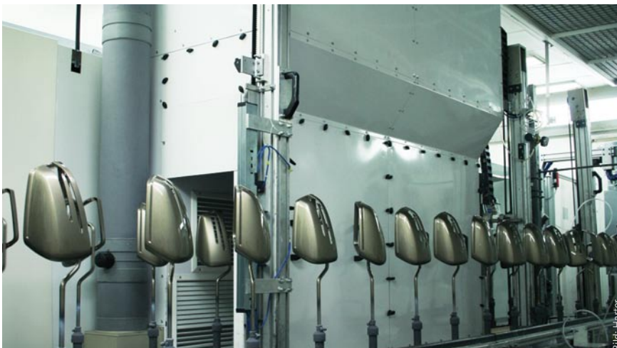
Die niedrigen Temperaturen bei der neuen Lacktrocknung schonen auch die Kunststoffbauteile
